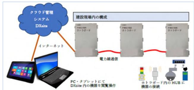
仮設分電盤によるネットワーク環境構築
