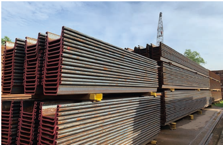
鋼矢板(シートパイル)
